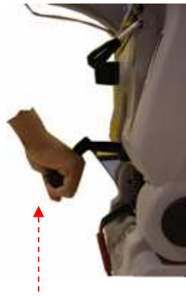
Der Saugfuß wird mit einem Handgriff gesteuert
